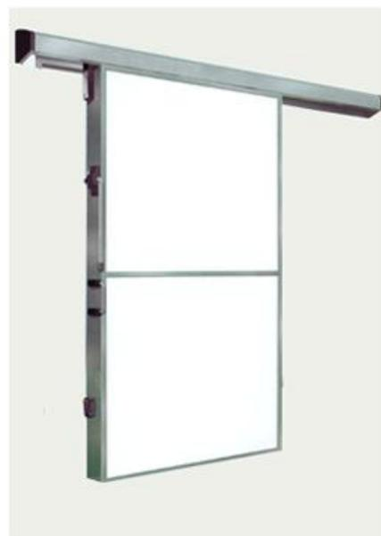
Двери технические откатные выполнены методом наполнения полиуретаном плотностью 43 кг/м<sup>3</sup> и толщиной 70 мм. Полотно двери изготавливается из стального листа с полиэстерным покрытием (Food Safe), который соответствует требованиям санитарно-пищевой отрасли.
