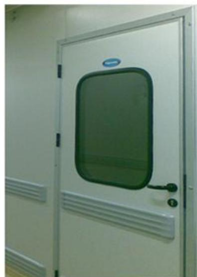
Двери технические офисные выполнены методом наполнения полиуретаном плотностью  $43 \text{ кг/м}^3$  и толщиной 40 мм. Полотно двери изготавливается из стального листа с полиэстерным покрытием (Food Safe), который соответствует требованиям санитарно-пищевой отрасли. Профиль рамы полотна, коробка и притворный Г-профиль выполнены из анодированного алюминия.
